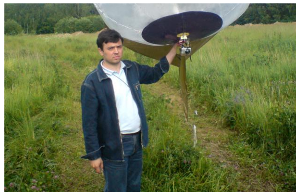
Рис. 2. Фотоаппаратура, установленная на гибридном аэростате К-01 Колибри.
